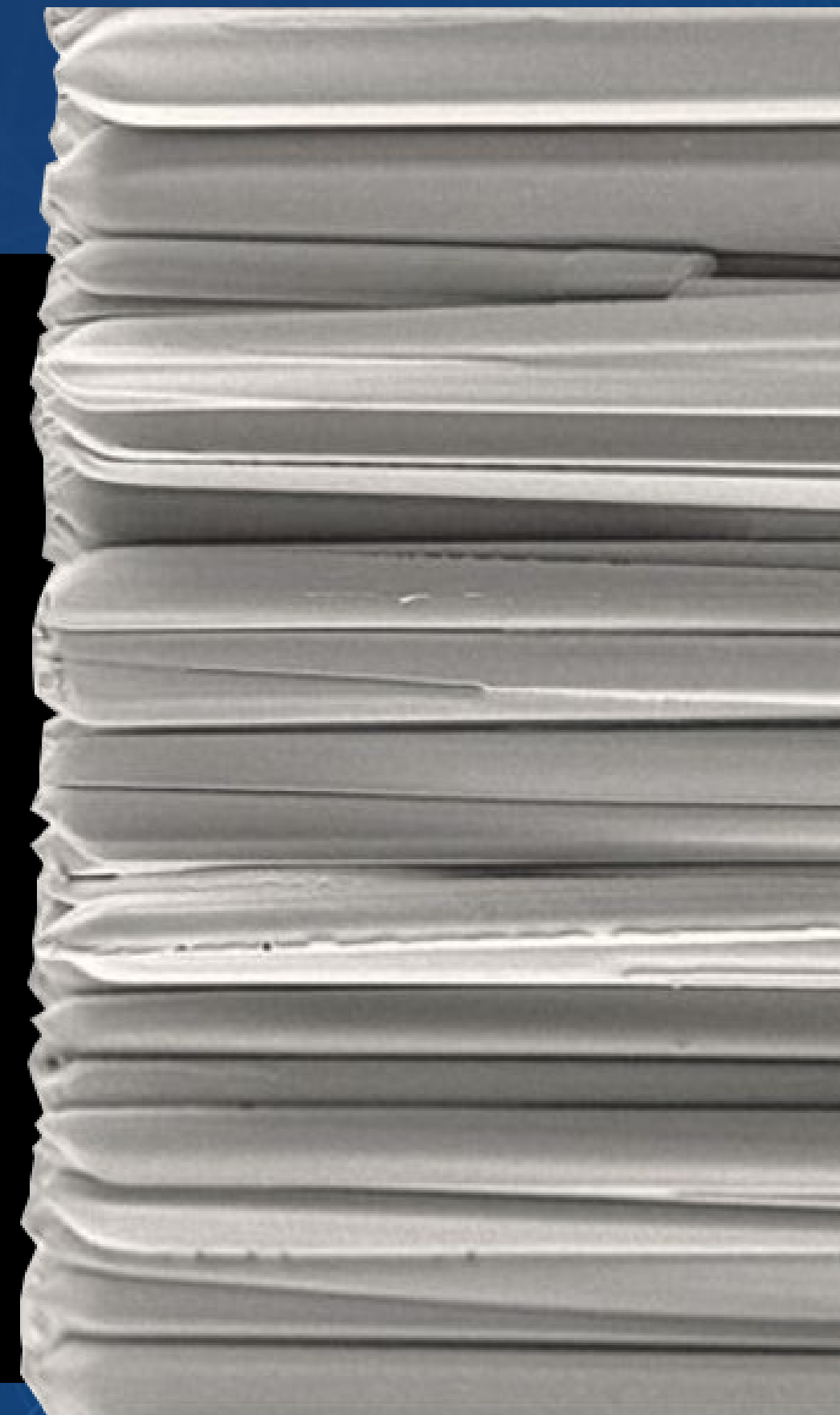
Seção transversal dos cintiladores CsI Cristais em forma de agulha
